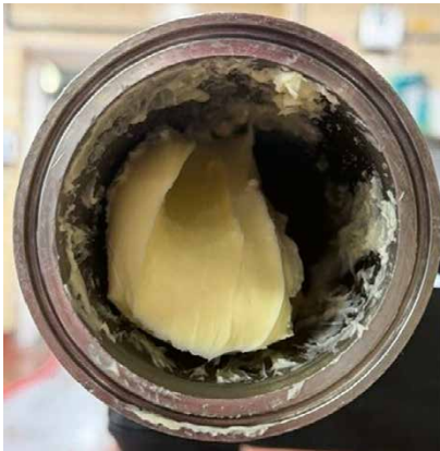
Querschnitt durch Rohrleitungen der Butterproduktion. Das Complex® Verfahren spart bei der Reinigung von Butteranlagen bis zu 90 Prozent Wasser im Vorspülprozess. Zudem verkürzt es jeden Zyklus um mehr als 16 Minuten, reduziert Laugenverbrauch, Butterverluste und Entsorgungskosten.
