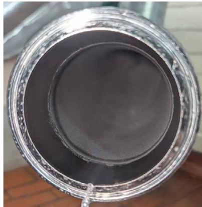
Querschnitt durch Rohrleitungen der Butterproduktion. Das Complex® Verfahren spart bei der Reinigung von Butteranlagen bis zu 90 Prozent Wasser im Vorspülprozess. Zudem verkürzt es jeden Zyklus um mehr als 16 Minuten, reduziert Laugenverbrauch, Butterverluste und Entsorgungskosten.
