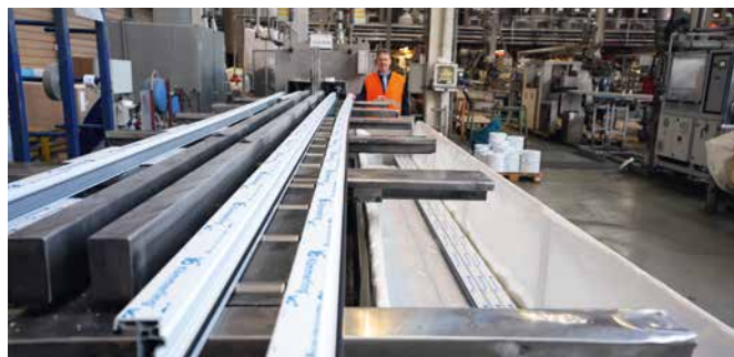
Herstellung von Kunststoffprofilen am Extruder
